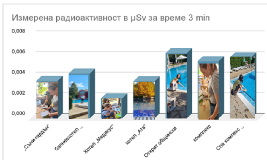
Графика 5. Измерена радиоактивност на минерални води на откритите минерални басейни на територията на община Вършец
